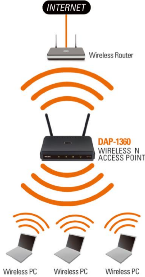
شكل رقم ١٠٨: استخدام (DAP 1360) في وضعية المكرر (Repeater)
